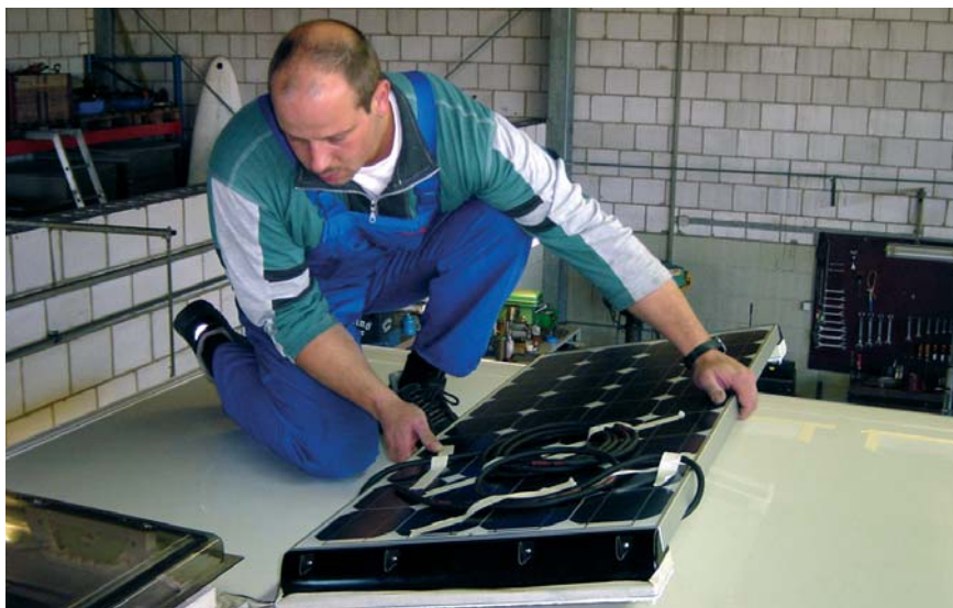
Bewährte Lösung: Durch die Montage der Solarmodule auf Spoilerprofile, die dann auf dem Reisemobildach sicher verklebt werden, wird eine optimale Unterlüftung der Module garantiert.
